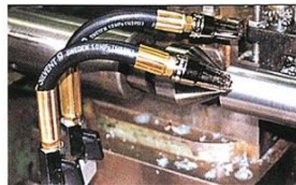
Silvent 220 切削中の大径ピストンロッドの清掃
