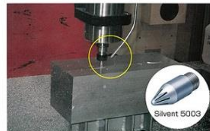
Silvent 5003 NC旋盤の清掃
