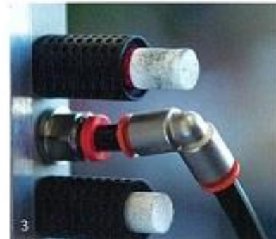
1. 通常時のサイレンサー。 2. ある程度詰まっている状態のサイレンサー。 3. 警告インジケータが見えたら交換時期です。
