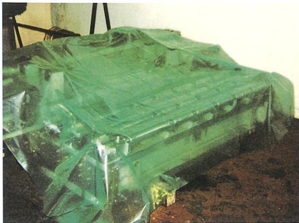
機械部品の整備、手入れ後の保管にはフィルムタイプを御使用下さい。気化性防錆剤塗布後にフィルムで覆うと効果は倍増します。
