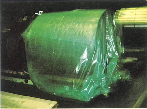
調質圧延前の中、長期滞貨材の防錆には、Fタイプ(鉄系)のフィルムで覆っておけば安心です。
