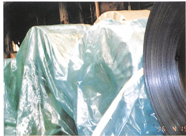
精整仕掛コイルにフィルム覆いをしておきますと、結露、雨洩れによる錆発生のお心配はありません。
