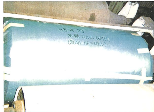
ロールや整備部品で長期保管の必要なものには気化性防錆油か、気化性防錆液の塗布やフィルム覆いでの保管が防錆に最適です。整備直前の部品の手入れ作業の省略で、整備時間の大幅な短縮が期待できます。
