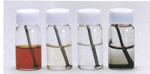
(A) 鉱物系防錆油 (B) 有機溶剤系防錆液 (C) 水溶性防錆液 (D) 水のまま 気化性防錆剤添加液の中では金属は錆びません。
